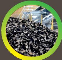
Respectant un cahier des charges précis (charte Qualigom®) le DRAINGOM® se présente sous la forme de petites pièces de pneus (chips) d'une taille calibrée entre 5 et 15 cm. La production du matériau est assurée par des plateformes ICPE, agréées pour la collecte et le traitement des pneumatiques usagés et utilisant des technologies de cisailage précises.
